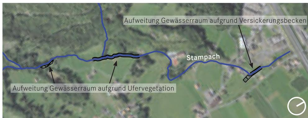
Abb. 16: Aufweitung Stampach für Ufervegetation resp. Hochwasserschutz (Versickerungsbecken). Ohne Massstab.
